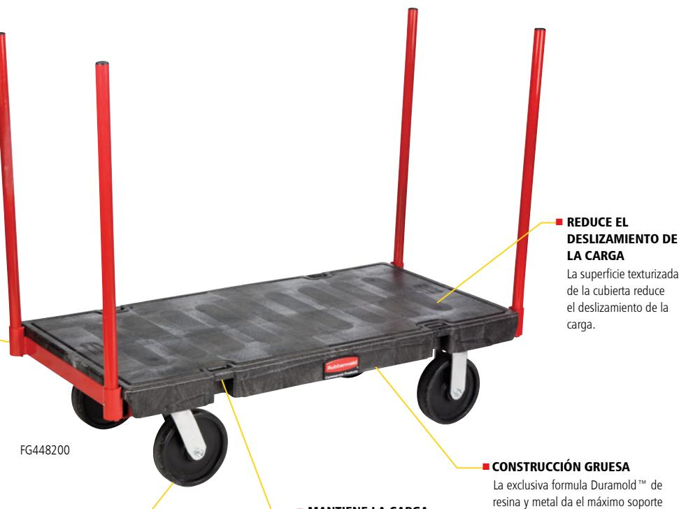
Sus ruedas de poliolefina de rodamiento grueso giran con mayor facilidad que las ruedas suaves; no dejan marcas y resisten los impactos y los químicos; no se deforman con cargas estáticas y no se pican con rebabas metálicas, clavos u otras rebabas. Excelentes para superficies de concreto, madera, alfombra o acero.
